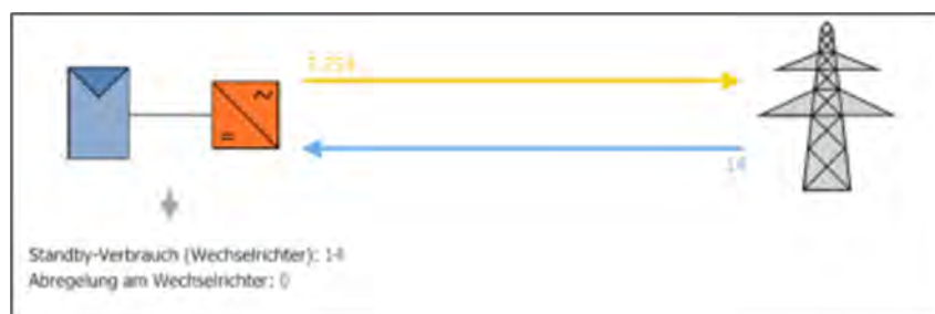
Abbildung 10-3: Energieflüsse Volleinspeisung, Quelle: PV*SOL
